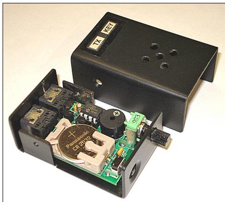
**Bild 1:** Ansicht des PicoKeyer-Plus von HamGadgets im selbstgebauten Gehäuse
