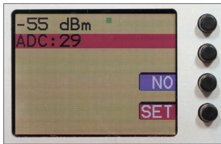
Bild 16: Kalibrieren des ersten Wertes bei -55 dBm
