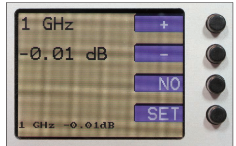
Bild 20: Der Leistungsmesser kann den Frequenzgang des Detektors mittels hinterlegter Korrekturdaten rechnerisch kompensieren.
