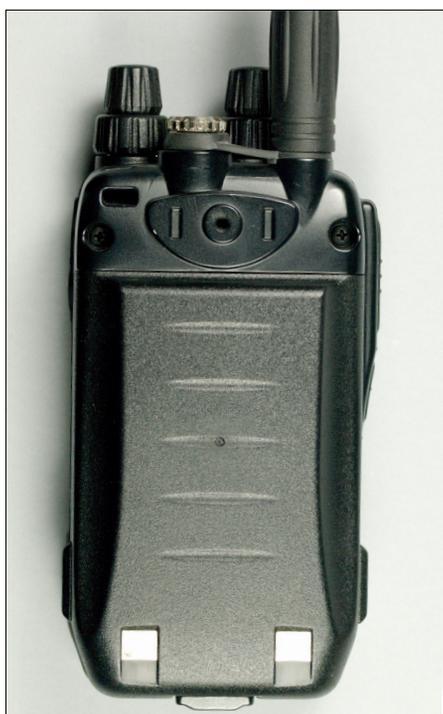
**Bild 11:** Die Rückseite des DJ-G7E wird überwiegend vom Akkumulator ausgefüllt.
