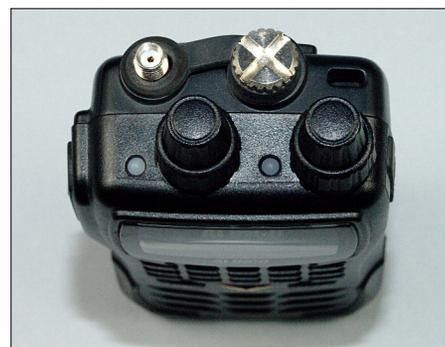
**Bild 7:** Das Alinco DJ-G7E von oben; links oben sieht man die SMA-Buchse zum Aufschrauben der Antenne. Rechts daneben die Buchse zum Anschluss von Kopfhörer und externem Mikrofon. Darunter befinden sich die beiden Multifunktionsknöpfe für die beiden VFOs und die zugehörigen LEDs zur Statusanzeige.
