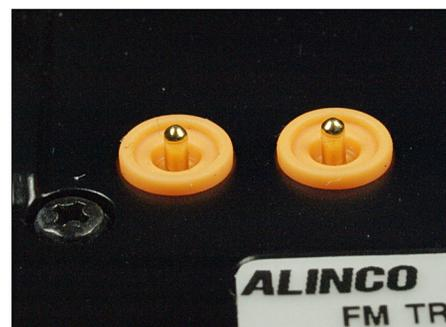
**Bild 13:** Der Anschluss des Akkus erfolgt über federnd gelagerte und vergoldete Kontaktstifte.
