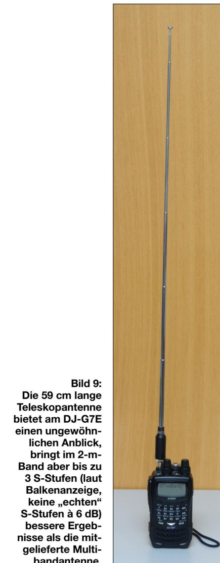
**Bild 9:** Die 59 cm lange Teleskopantenne bietet am DJ-G7E einen ungewöhnlichen Anblick, bringt im 2-m-Band aber bis zu 3 S-Stufen (laut Balkenanzeige, keine „echten“ S-Stufen à 6 dB) bessere Ergebnisse als die mitgelieferte Multi-bandantenne.
