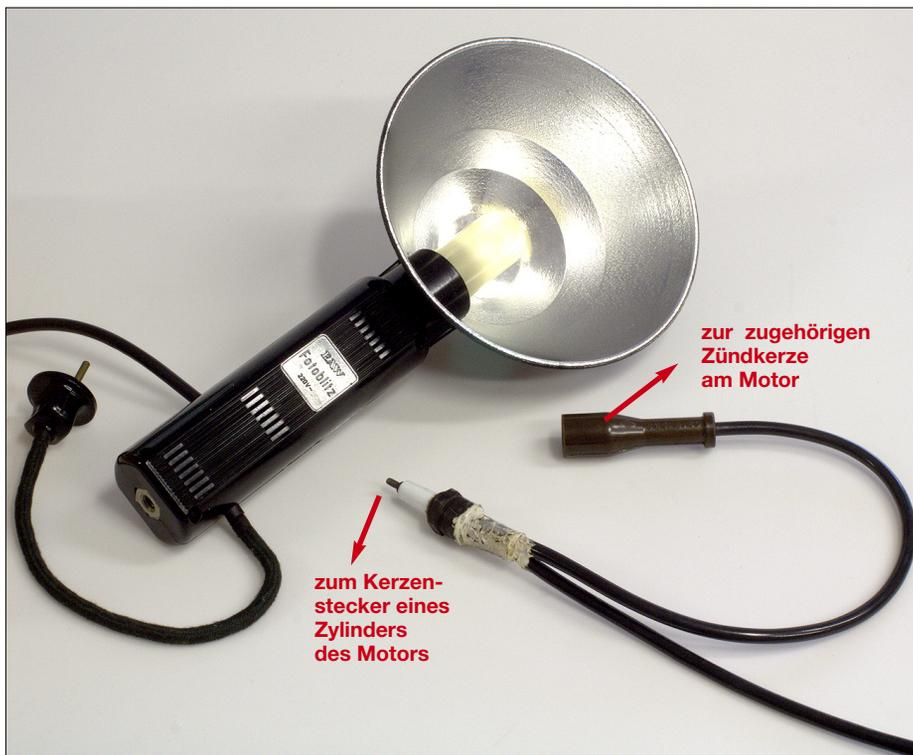
Dieses selbst gebaute Lichtblitzstroboskop zur Ermittlung des Zündzeitpunktes von Otto-Motoren basiert auf einem normalen, industriell hergestellten Blitzgerät. Foto: Red. FA
