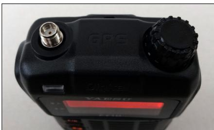
**Bild 24:** Unauffällig integriert sich die GPS-Antenne in die Oberseite des Gehäuses.
