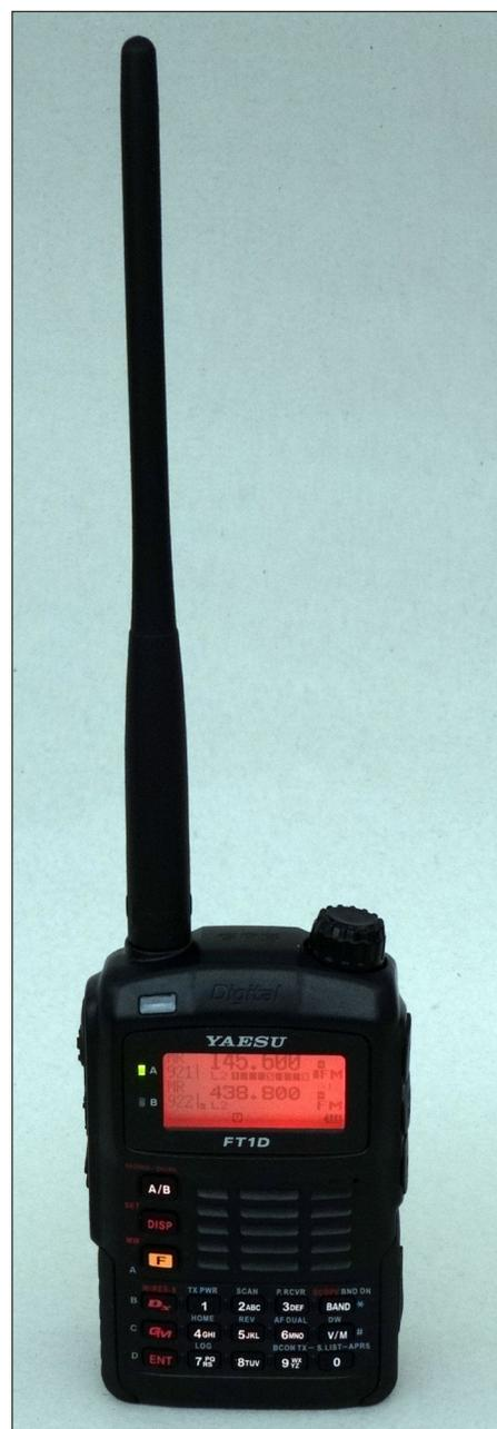
Bild 21: Mit bis zu 5 W Sendeleistung und der Standardantenne lassen sich bereits gute Reichweiten erzielen.
