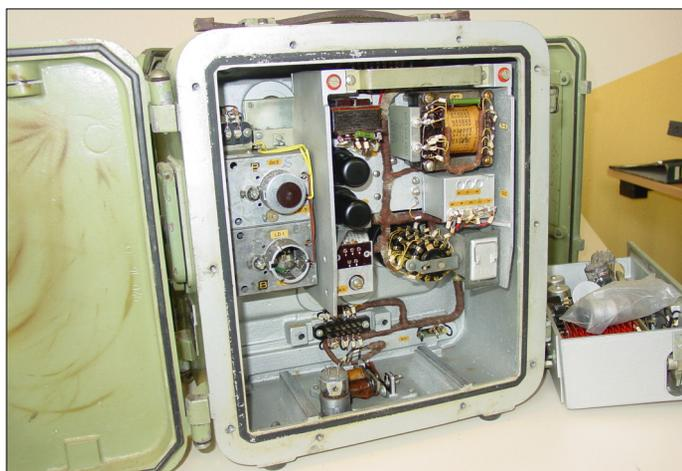
**Bild 1: 500-MHz-Dezi-Telefon, Frontplatte abgenommen; umgebaut ließ sich das Gerät für AM-Funkverbindungen im 70-cm-Amateurfunkband nutzen.**
