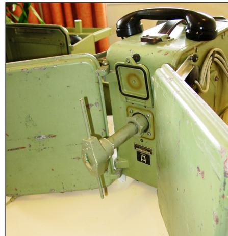
**Bild 3: Dezi-Telefon, Blick auf die Rückseite; hier wurde die zum Gerät gehörende Antenne befestigt.**
