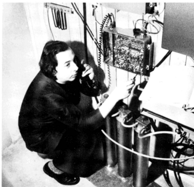
Bild 2: Peter Abschlag hat als Relaiswart eine verantwortungsvolle Funktion. Ihm obliegen die Wartung und Reparatur der technischen Einrichtungen des Relais. Peter überprüft hier gerade die Funktion des Empfängers (geöffnetes Gehäuse). Auf dem Boden stehend ist der Duplexer gut zu erkennen.
