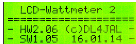
Bild 69: LCD-Anzeige nach dem Einschalten (Power ON) mit den allgemeinen Informationen der Baugruppe.
