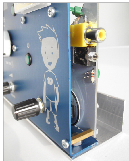
Bild A4: Die Cinch-Buchse des 10,7-MHz-ZF-Ausgangs musste verlegt werden.
