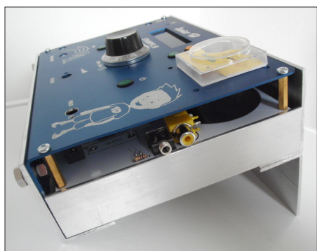
Bild A1: Junior 1D mit einem Gehäuse aus Aluminium-Winkelprofil, Seitenansicht
