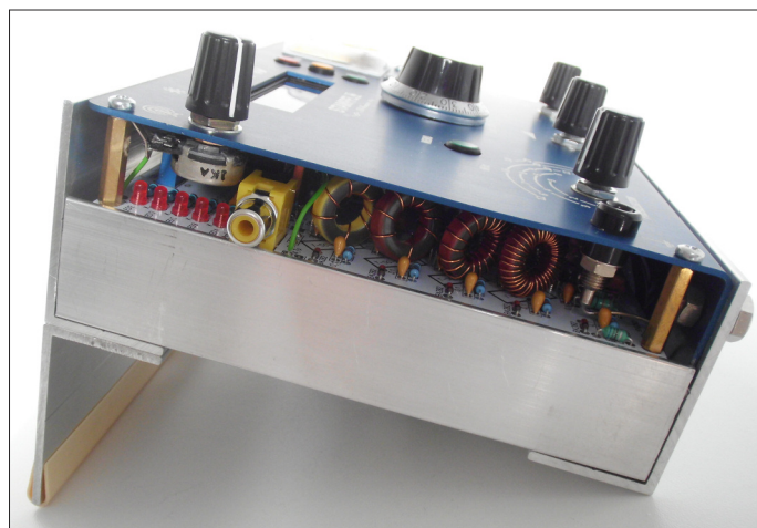
Bild A7: Gehäusewanne aus Aluminium-Winkelprofilen mit dem nach unten gerichteten Lautsprecher
