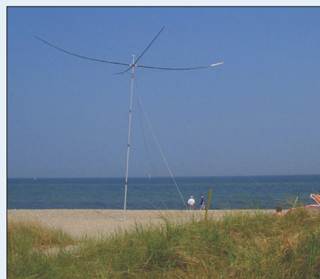
Spider Beam von DF4SA am Strand – eine vollwertige Yagi für 10, 15 und 20 m, die es inzwischen auch als Bausatz zu kaufen gibt.
