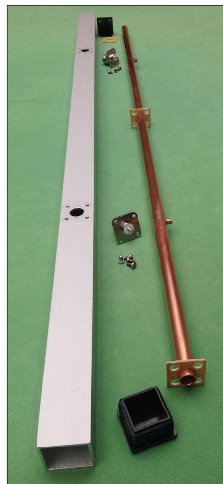
**Bild 13:** Fur die alternative Realisierung des Filters aus Rohren sind nur wenige Einzelteile erforderlich. Die N-Buchsen besitzen einen Innenleiter mit M3-Gewinde, sodass die Endmontage sehr einfach ist. Wegen der guten Lotbarkeit mit den Messingnippeln empfiehlt sich ein Innenleiterrohr aus Kupfer.
