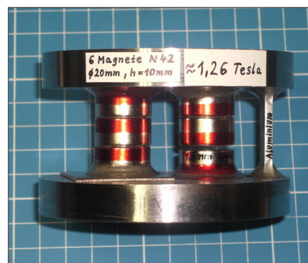
Bild 18: Anordnung aus sechs Neodym-Magneten
