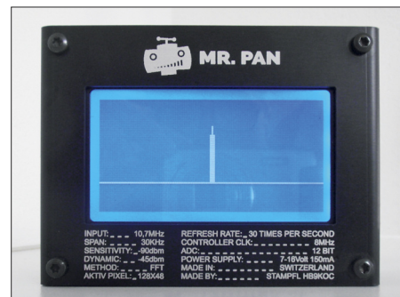
Bild E4: Das Panorama-Sichtgerät Mr. PAN, zeigt ein Spektrum +/-15 kHz um die eingestellte Mittenfrequenz an.
