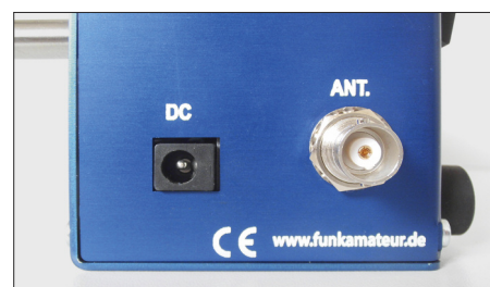
Bild E6: BNC-Antennenbuchse und Stromversorgungsbuchse an der rechten Empfängerseite
