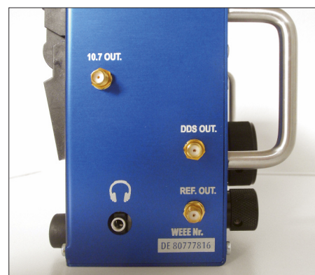
Bild E5: SMA-Buchsen für ZF-Ausgang 10,7 MHz, DDS-Signal und TCXO; die Stereo-Klinkenbuchse dient zum Anschluss des Kopfhörers.
