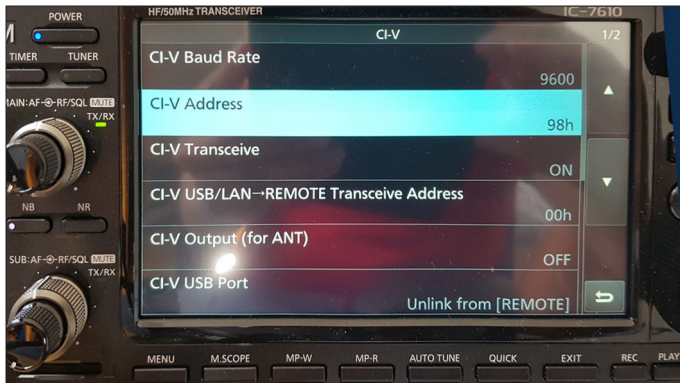
Einstellung der Adresse der CI-V-Schnittstelle im Icom IC-7610 Fotos: DL2KCK
