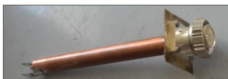
Bild 24: Innen- und Außenleiter des Sperrtopfes zusammengebaut, Fahnen angelötet
