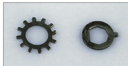
Bild 7: Diese beiden Scheiben sind von der Achse zu nehmen.
