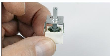
**Bild 13:** Das Halteblech wird wieder so weit über den Kunststoffkörper geschoben ...
