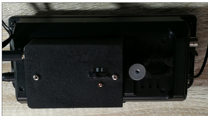
Bild 3: Die Lasche des Akkumulatorgehäus es wird auf der Rückseite des Transceivers eingeklemmt.
